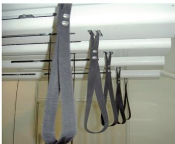
**Рис. 17.** Ручки для передвижения модулей.
